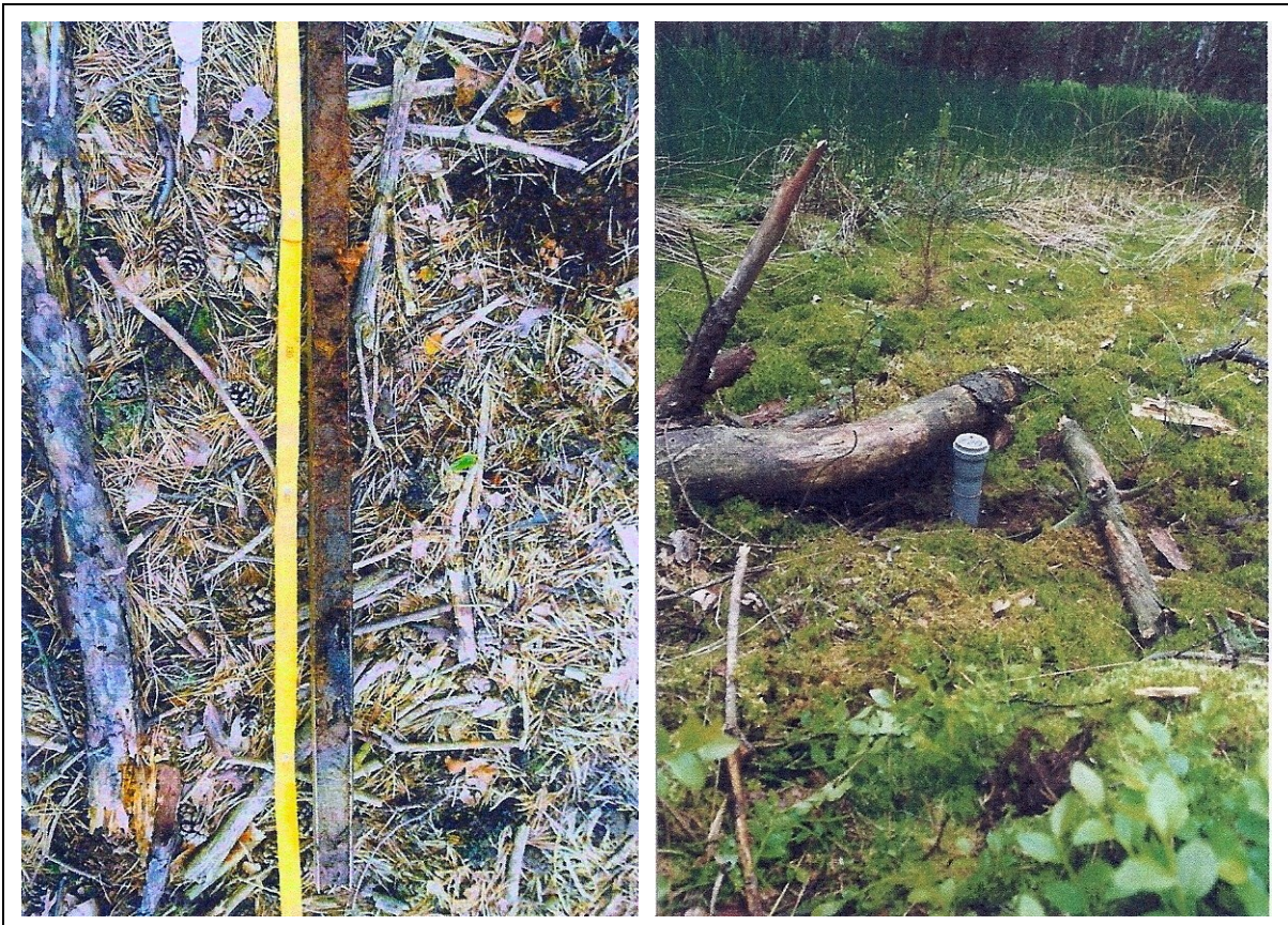
Abb. 8a: Kammerbohrer mit Sand- (grau), Mudde- (schwarz) und Torfinhalt (braun)
