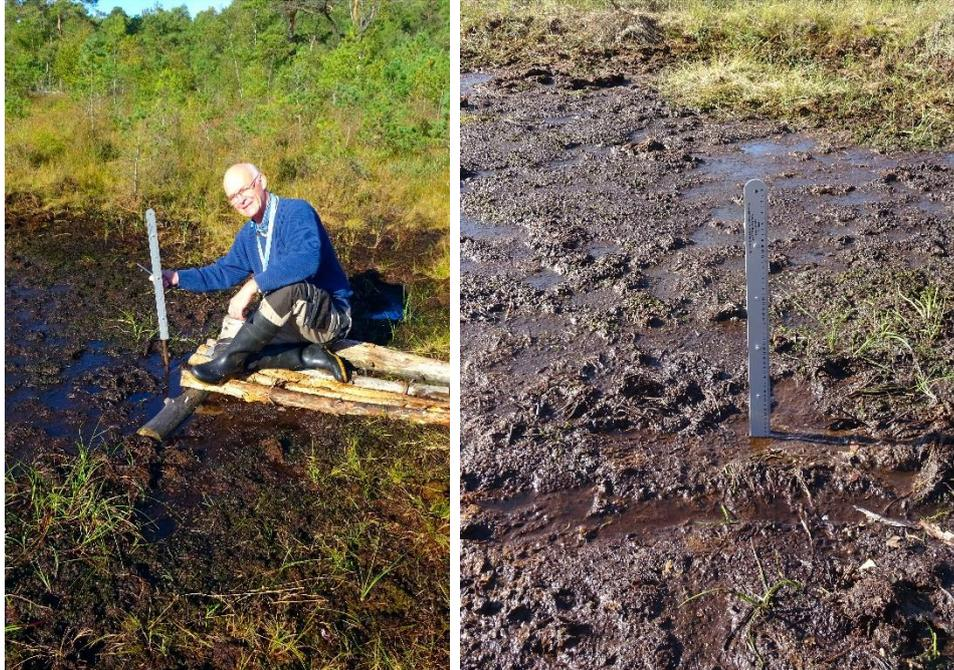
Abb. 4: Erneuerung der Pegellatte des Messpegels FER
