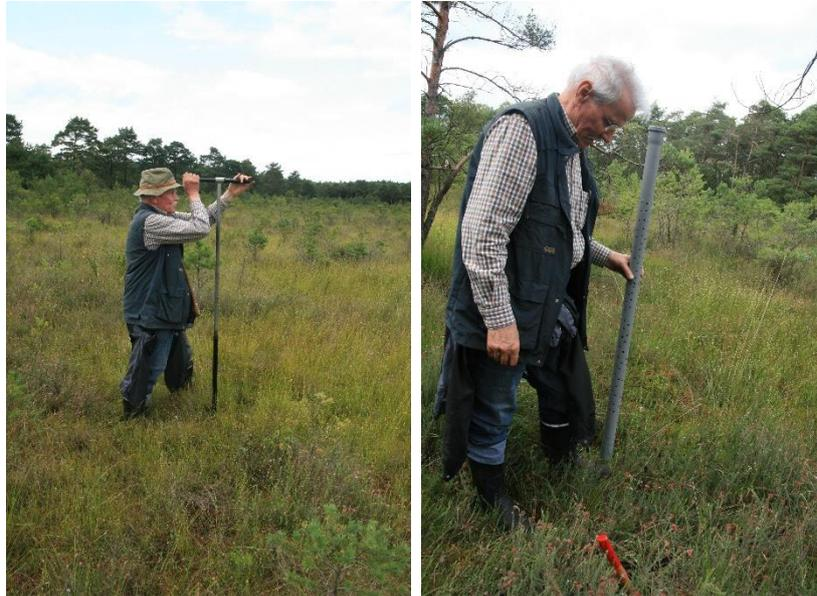
Abb. 2: Probebohrung am Pegel B16 und Einsetzen des Pegelrohres W25
