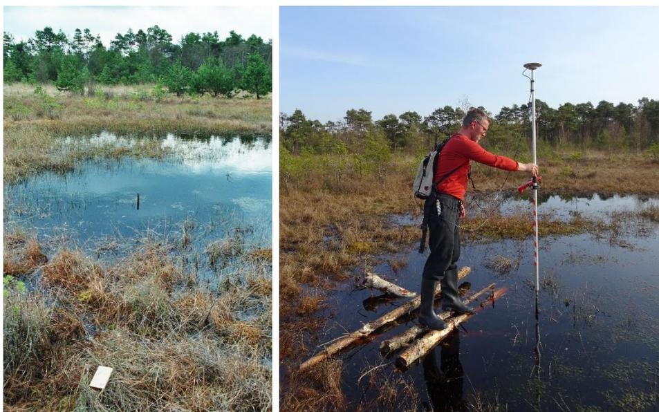
Abb. 3: Umfeld des Pegels FER (links 29.04.2001) und GNSS-Höhenbestimmung 2015
