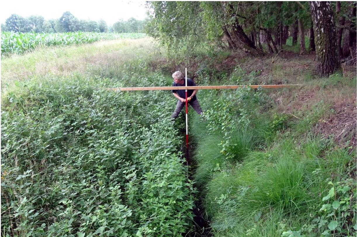
Abb. 164: Randgraben mit Lattenpegel Gr01 und Grabenvermessung
